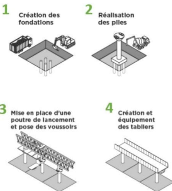
*Schéma expliquant les 4 étapes de construction d'un viaduc*
